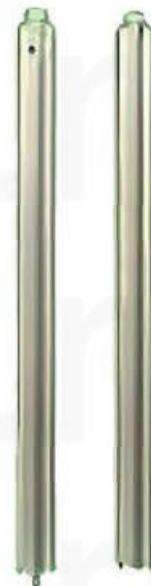
Модель пробоотборников для нефти FIP (Fixed In Place) не имеет встроенного клапана для отбора проб. Для соблюдения газонепроницаемости, данная модель должна устанавливаться исключительно на контрольный клапан с уже имеющимся отверстием для пробоотбора MBS.
